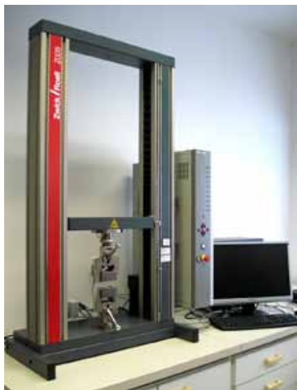
Slika 1: Univerzalni namizni testirni stroj Zwick Z005 v laboratoriju za lepljenje (foto: M. Šernek)
