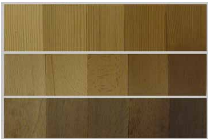
Slika 2. Modificirana smrekovina, bukovina in hrastovina – različne stopnje modifikacije
