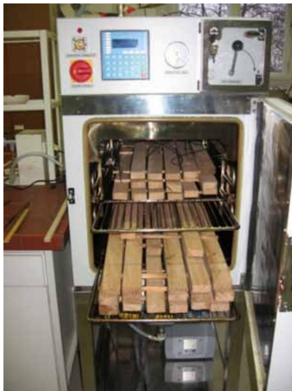
Slika 1. Laboratorijska komora za termično modifikacijo lesa z začetnim vakuumom
