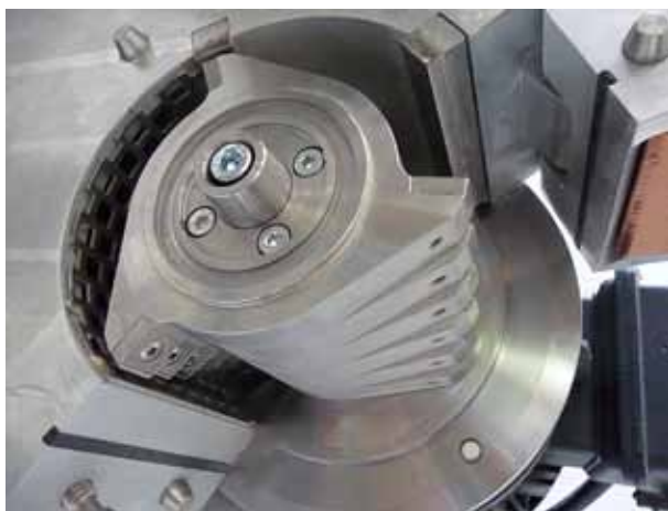
Slika 1. Detajl nožev rezalnega mlina za les, ki so razporejeni v obliki spirale
