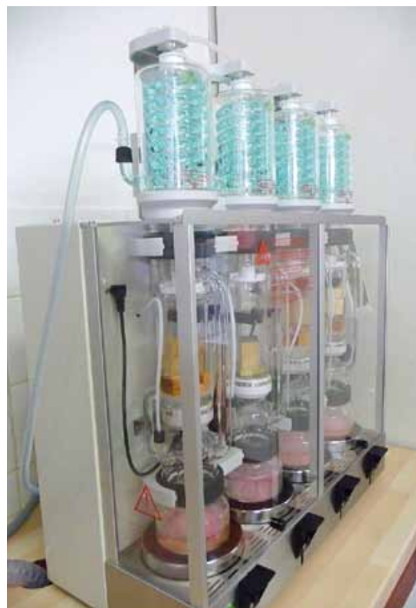
Slika 2. Ekstrakcijski aparat Soxhlet podjetja Büchi (B-811 LSV 230V)
