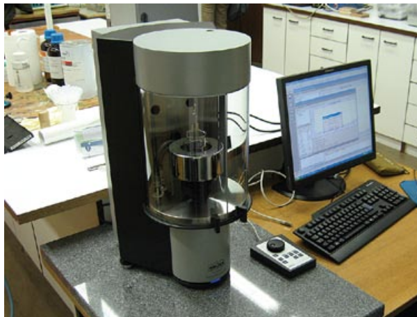
■ Slika 1. Tenziometer K 100, proizvajalca Krüss GmbH iz Nemčije (foto: Borut Kričej)
