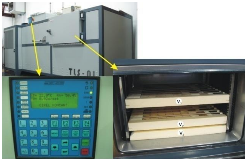
Slika 1 Ekperimentalni konvekcijski sušilni kanal TLS-01 (zg. levo) s PLC krmilnikom (sp. levo) in z ekperimentalno komoro (sp. desno).
