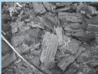
□ Slika 5. Z glivami rjave trohnoobe razkrojen les Figure 5: Brown rotted wood
